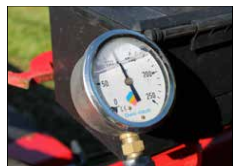
Un manomètre permet de mesurer la pression au sol
