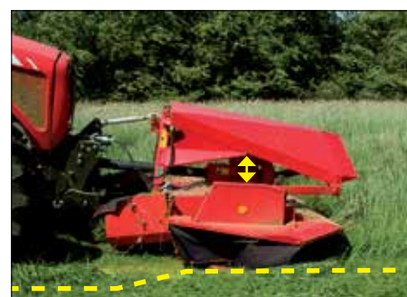
Contour Float - absorbe les irrégularités du sol
