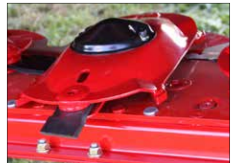
Disque Q+ avec couteaux plats vrillés
