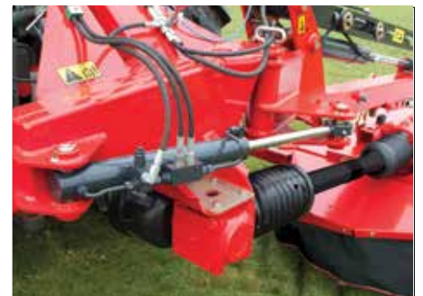
Sécurité hydraulique anti-pierres
