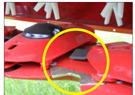
Le contre couteau se place 2 mm au dessus du lamier.
