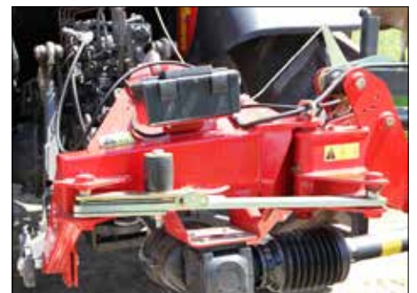
Sécurité mécanique anti-pierres
