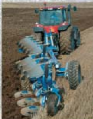
Överum DXL 81075 H. Gali būti nustatytas 35, 40, 45 cm vagos plotis. Optimali prošvaisa arimui be stabdymo esant dideliems grumstams.
