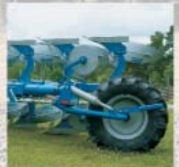
Ypač didelio diametro ratas su hidrauliniu valdymu ir paprastu gylio reguliavimu.
