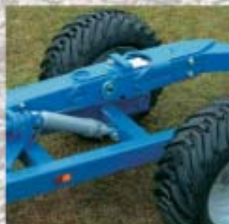
Överum CXL plūgų platformoje yra įrengta masyvi plieno lakšto spyruoklė, leidžianti plūgo galui arti vienodame gilyje.
