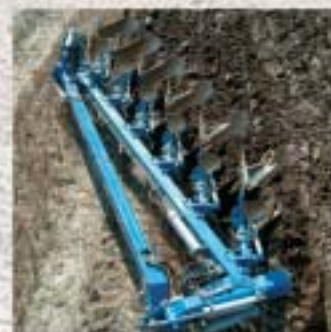
Visos šoninės jėgos subalansuotos pagal Överum pusiau pakabinamo plūgo technologiją.
