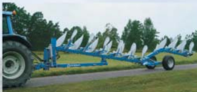
Överum 91075 F. Nukerpamo varžto apsauga nuo akmenų. Transportavimo padėtyje CXL žemai esantis svorio centras.
