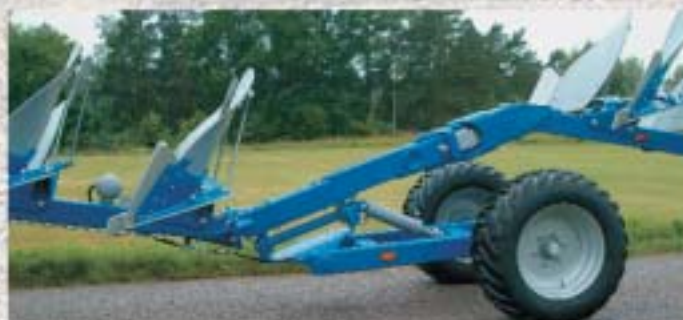
Svorio pasiskirstymas išilgai rėmo leidžia CXL modelio plūgui lengvai manevruoti. Hidraulinė pakaba pakėlimo cilindre padeda tolydžiam ir saugiam transportavimui.
