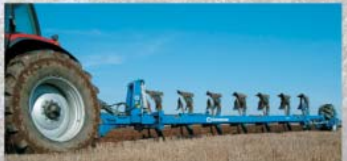
Rėmas yra sukonstruotas aukštai tam, kad pagerintų prošvaisą.
