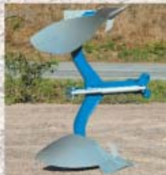
Atramos iš ypač tvirto profilio suteikia optimalią prošvaisą.
