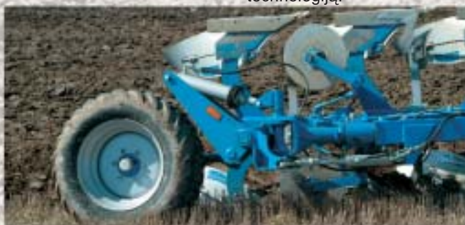
Didelis ratas su nedideliu riedėjimo pasipriešinimu ir hidrauliniu vairavimu.
