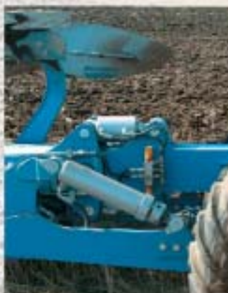
Överum DXL platforminiai plūgai turi hidraulinio būdu valdomą jungtį, plaukiančioje padėtyje arimo metu.
