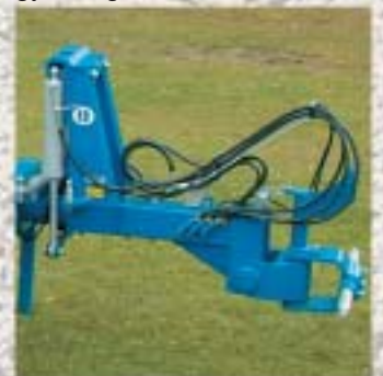
Ypač stiprūs: tempimo rėmas ir pasukimo galvutė.
