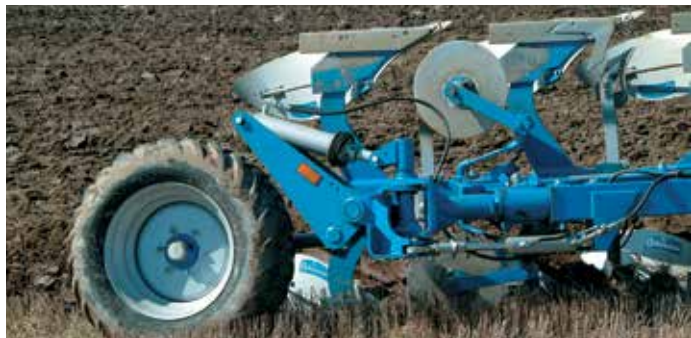
Alacsony gördülési ellenállású széles kerék és hidraulikus kormányzás.
