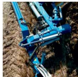
Az első ekefej fogásszélességének hidraulikus állítása alapkvittel.
