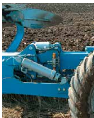
Az Överum DXL vontatott ekék csuklópontja hidraulikusan szabályozott, ami szabadon rugózik úszó helyzetben szántás során.
