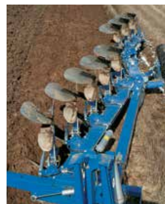
Överum DXL 81075 H. A fogásszélesség 16, 18 vagy 20 collra állítható be. Az átömlési keresztmetszet sok tarlómaradvány esetén is folyamatos szántást biztosít.
