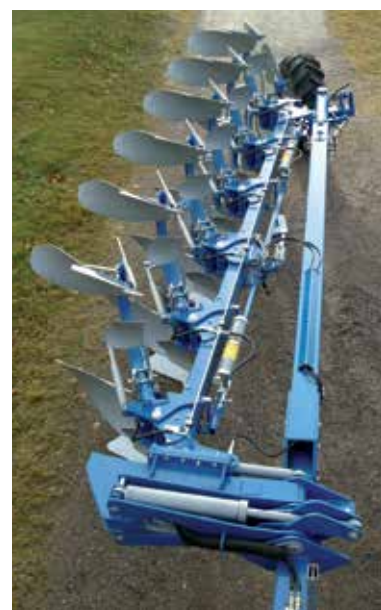
Az erősített váz kialakítása az optimális geometriával alacsony erőszükségletet kíván a fogásszélesség állításakor.
