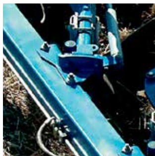
A fogásszélesség állítható - 14", 16" vagy 18" (35, 40 vagy 45 cm).
