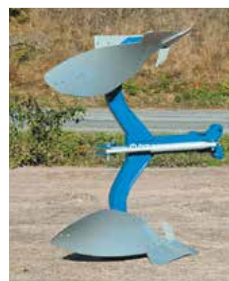
Az erősített profilú szárak optimális magasságot biztosítanak.
