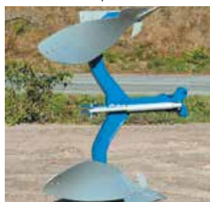
Az erősített profilú szárak optimális magasságot biztosítanak.
