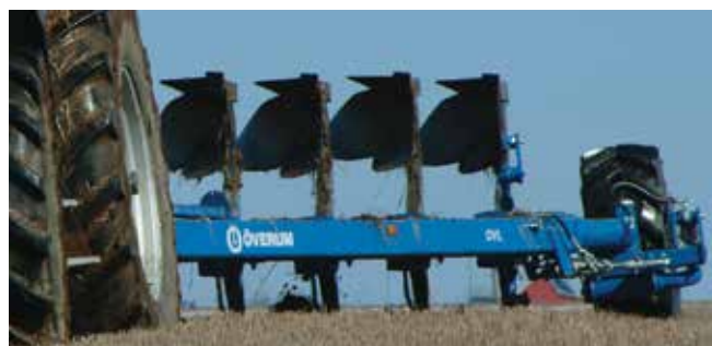
A váz magas kialakítású az áteresztés javítása érdekében.
