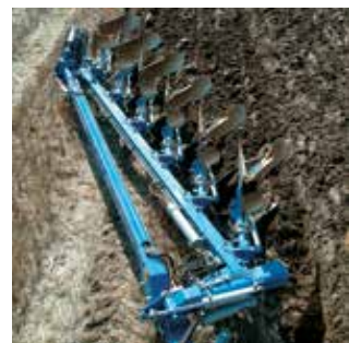
Az oldalirányú erők automatikusan kiegyenlítődnek az Överum félig függesztett eke kialakításával.
