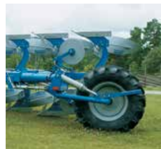
Különösen nagy átmérőjű kerék hidraulikus kormányzással és egyszerű mélységállítással.
