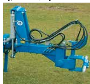
Igen szilárd váz és átfordító torony.
