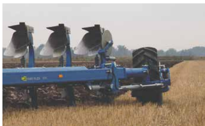
Széles hátsó mélységghatóró kerék (420/70 R24) az optimális tömegeloszlás és a nehéz körülmények közötti üzemeltetés érdekében. A fogásszélesség állítása esetén egy munkahenger biztosítja a kerék helyzetének utánállítását.
