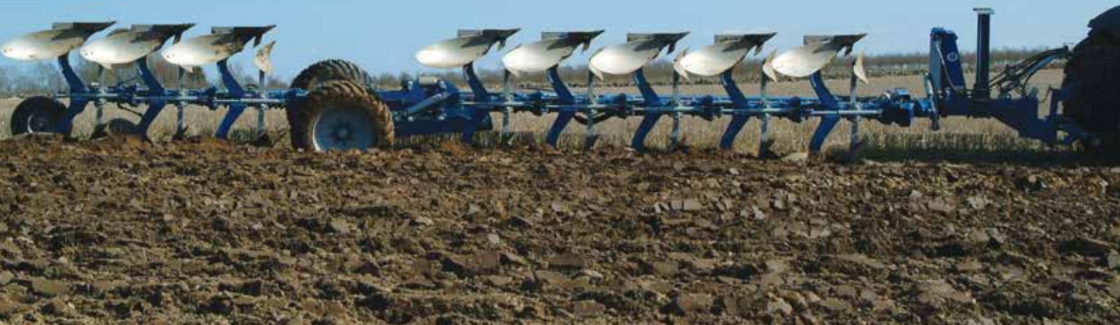
Överum DXL 81080 H. A nagy átmérőjű kerekek (400x26.5) megfelelő alátámasztást és mélységtartást biztosítanak nehéz körülmények között is.
