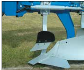
Rasettes EP, versoirs en plastique pour les terres collantes
