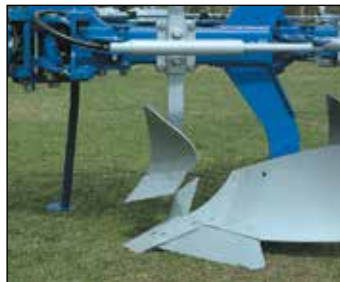
Rasettes EM, Pour labour en présence d'importante quantité de résidus. Excellent travail en combinaison avec coute incorporés.
