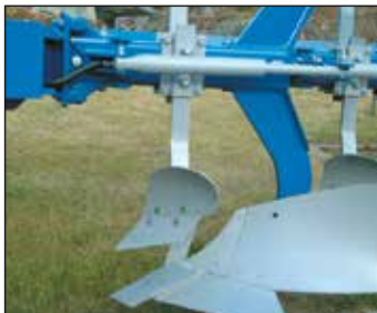
Rasettes EG pour une découpe large et peu profonde. Très bon travail en combinaison avec coute circulaire et incorporé.
