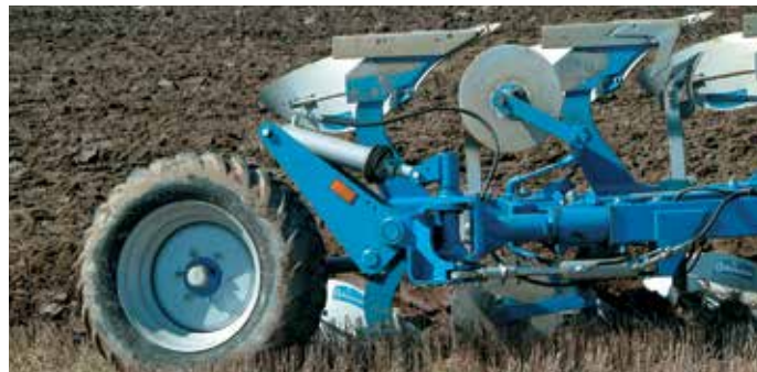
La roue large procure peu de résistance, ici avec sont vérin.
