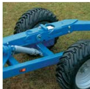
La poutre arrière possède une suspension ressort surdimensionnée afin de travail indépendamment de l'avant.
