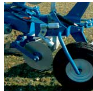
La roue arrière contrôle la profondeur des derniers corps.
