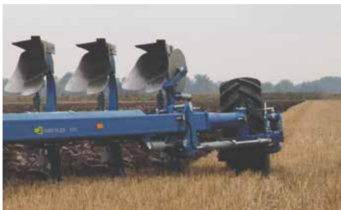
Roue large (420/70 R24) montée à l'arrière pour optimiser le report de charge et le travail en condition difficile.
