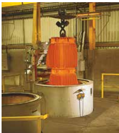
Cémentation des matrices de versoirs.
