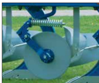
Coute circulaire lisse avec ressort de sécurité.
