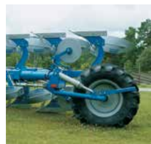
La roue large procure peu de résistance, avec son vérin.
