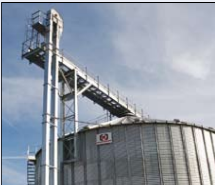
Kongskilde KBE kopelevatorer - skånsom lodret transport med lavt energiforbrug.
