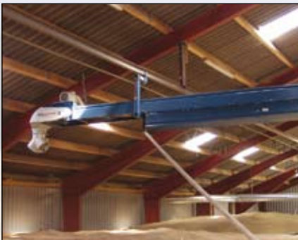
Kongskilde BCA transportbånd - ideel til sortsren, vandret transport, hvor der er knap med plads.
